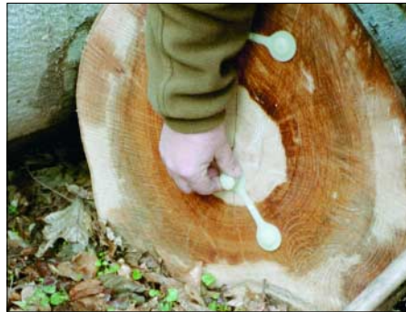
Abb. 4 bis 6: Die Handhabung des SavePlug-Systems ist einfach: Kunststoffklammer über den Riss legen und einen Verankerungsbolzen einschlagen. Nun kann das Halteband für Korrekturen frei bewegt werden!
