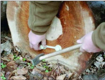
Abb. 4 bis 6: Die Handhabung des SavePlug-Systems ist einfach: Kunststoffklammer über den Riss legen und einen Verankerungsbolzen einschlagen. Nun kann das Halteband für Korrekturen frei bewegt werden!
