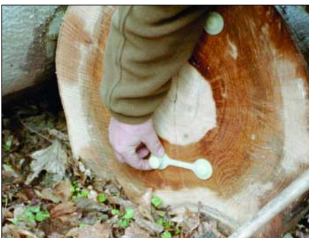
Abb. 6: Ist der optimale Sitz gefunden, wird das Halteband mit dem zweiten Verankerungsbolzen fixiert.
